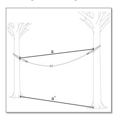
Um den Durchhang eines Seiles zu ermitteln, misst man zunächst den horizontalen Abstand zwischen den beiden Anschlagpunkten (a). Hat man zwei relativ gerade Bäume zur Verfügung, so kann man auch am Boden messen (a').
