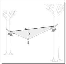
Danach wird jener Abstand gemessen oder pessimistisch geschätzt, den das Seil bei Belastung zur gedachten geraden Linie zwischen den beiden Anschlagpunkten unter Last maximal erreicht (b). Dividiert man nun diese beiden Werte (also b geteilt durch a), so erhält man den Durchhang. Liegt der Abstand zwischen den Bäumen beispielsweise bei 10 Meter und beträgt die Distanz b 2 Meter, so ist ein Durchhang von 0,2 oder 20 % gegeben.
