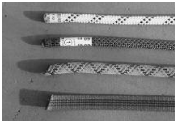
Seiltypen von oben nach unten: Statikseil, dynamisches Seil, Spielseil, Bandschlinge mit 3 Kennfäden
