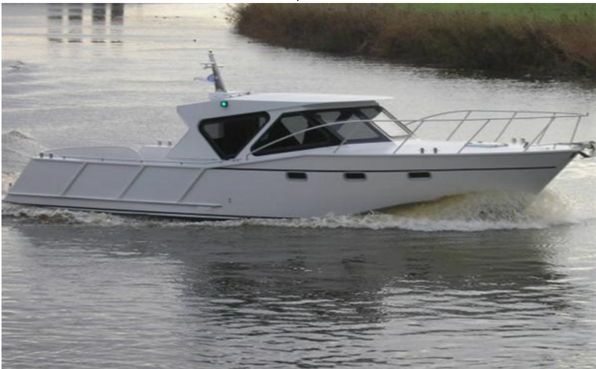
Stevens Nautical Subside 1050 OK Länge: 10,50 m, Breite: 3,70 m und Tiefgang: 1,00 m
